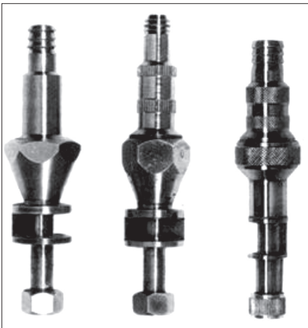
Figura 5 - Esempi di campionatori personali per polveri Figure 5 - Example of personal sampler for powders
